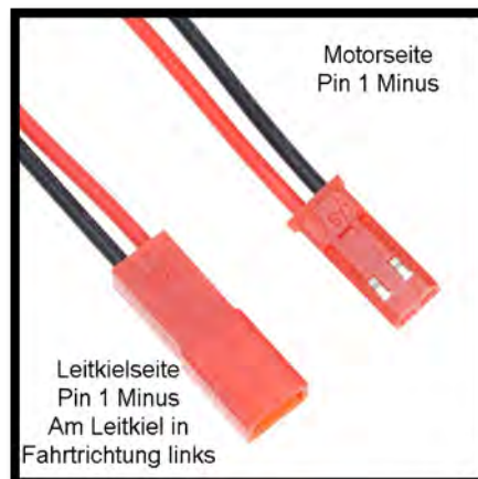
Pin-Belegung für Poolmotoren
